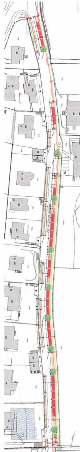
*Clos-de-Serrières ouest - Les surfaces en couleur sont des zones perméabilisées qui ne l'étaient pas sur la situation existante. Le trottoir sera réalisé en « stabiliser », un revêtement semi-perméable.*
